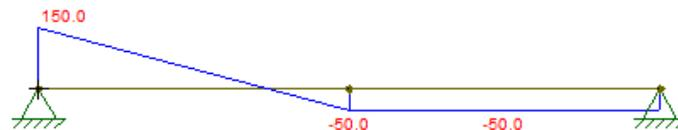
Figura 125: Diagrama de força cortante da barra principal
